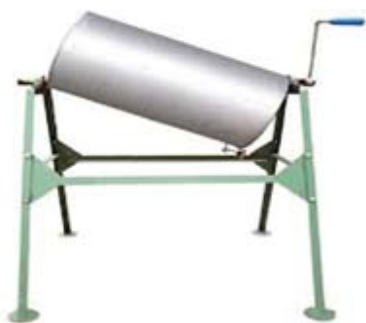
شکل ۲- عملیات بذرمال توسط محفظه دوار
