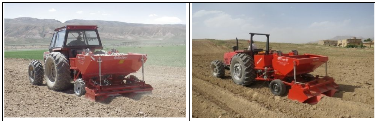
شکل ۵-۱۲- نمونه‌هایی از ماشین‌های کاشت دو ردیفه سیب‌زمینی. نوع ساده سمت راست و نوع زیگزاگ سمت چپ
