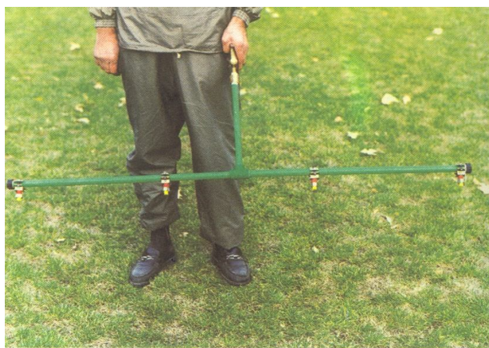
شکل 2- نمائی از بوم دستی جایگزین لانس
